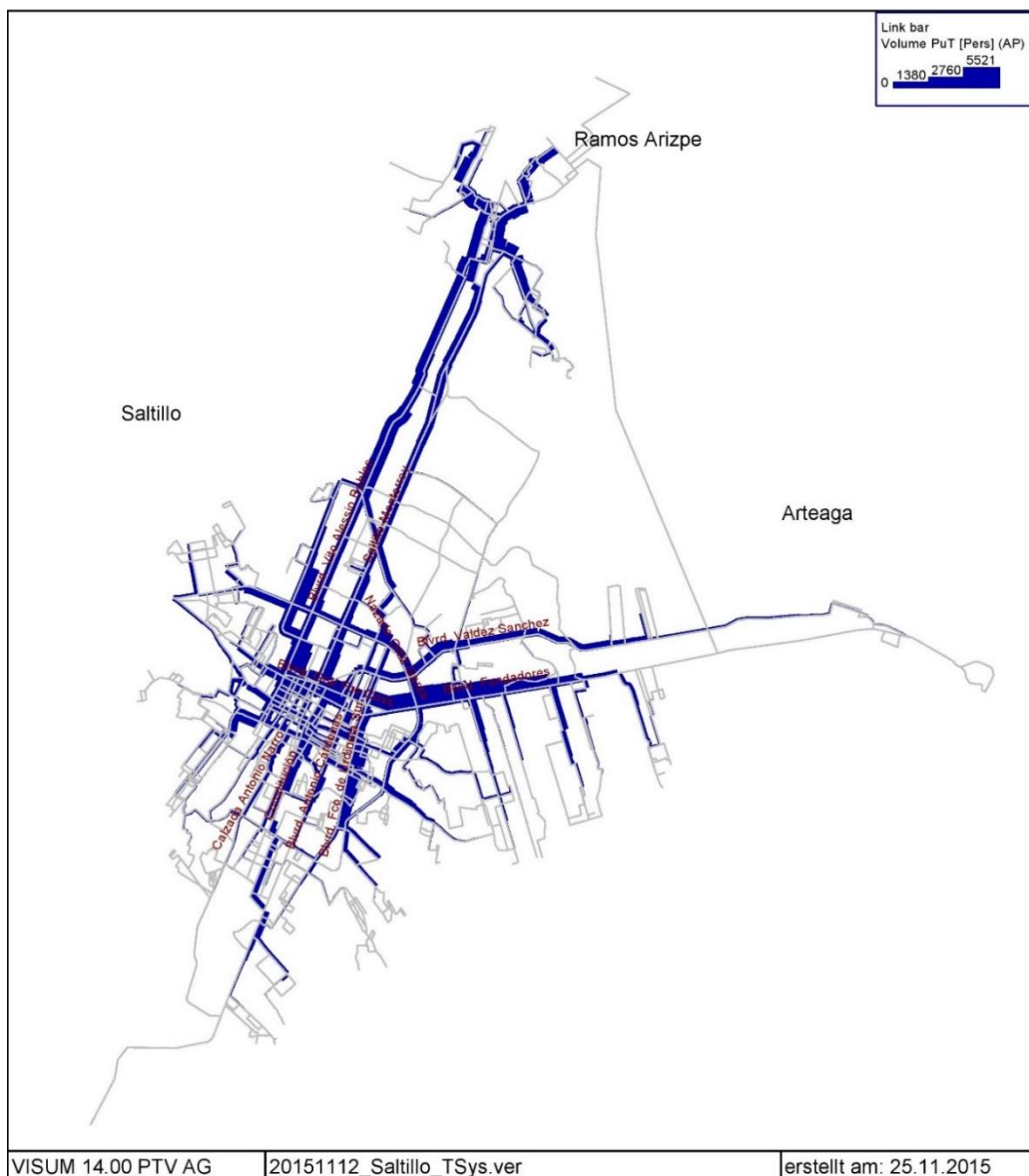
Imagen 22. Asignación de la matriz de transporte público sobre la red de Saltillo. Fuente: IDOM
